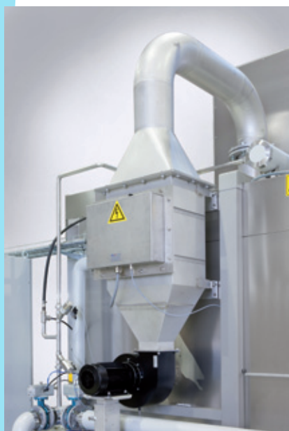
Secado integrado Circulación de aire caliente.
